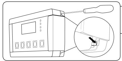
Déclipser le couvercle à l'aide d'un fin tournevis
