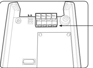
Bornier de raccordement du RC TAC4
